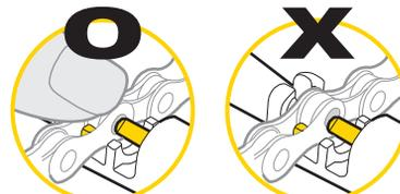
チェーンピンを挿入するときは、受け台からずれないようにしっかりとチェーンを押し付けるようにしてください。チェーンツールのプレスピンでチェーンピンの中心以外を押すとチェーンツールやチェーンを破損させる恐れがあります。必ずチェーンピンの中心を押すようにしてください。
