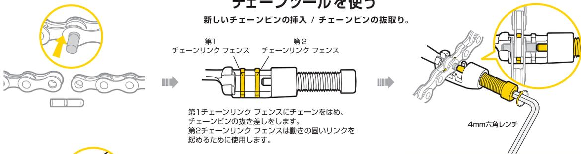
第1チェーンリンク フェンスにチェーンをはめ、チェーンピンの抜き差しをします。第2チェーンリンク フェンスは動きの固いリンクを緩めるために使用します。
